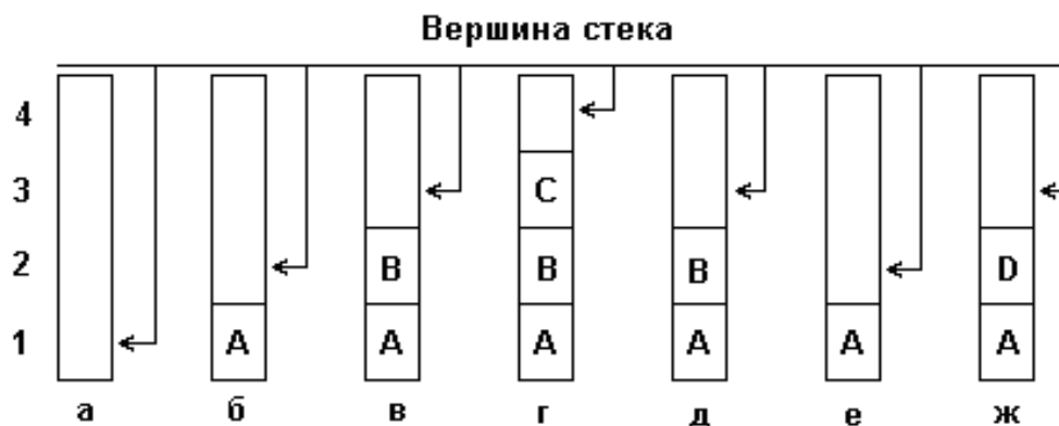
Рис 1. Включение и исключение элементов из стека
