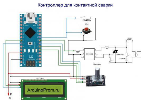
1-сурет. Контакттілі дәнекерлеудің қоректендіру схемасы
