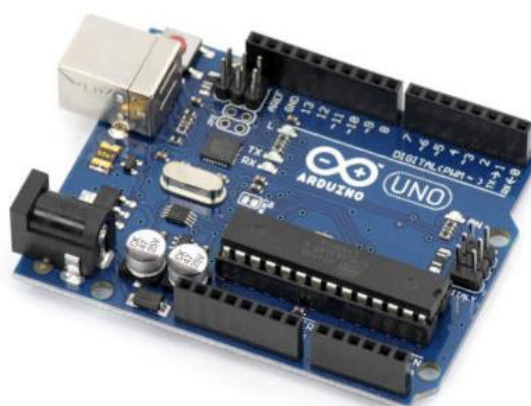
Сурет 1 – Arduino Uno роботы
